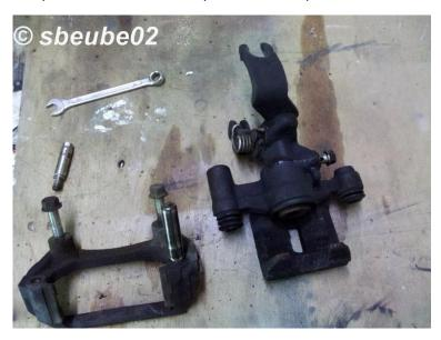
Attention ça chauffe! Pour décoller le frein filet, j'ai chauffé au chalumeau puis desserré avec la clé Allen de 6 mm.
