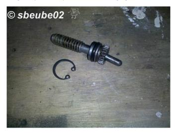
Insertion de la vis et de la tige dans son logement. On fixe le tout grâce au circlip.
