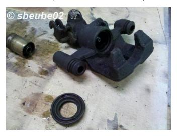
Au fond il y a un circlip qu'il faut retirer avec une pince à becs trèèes longs
